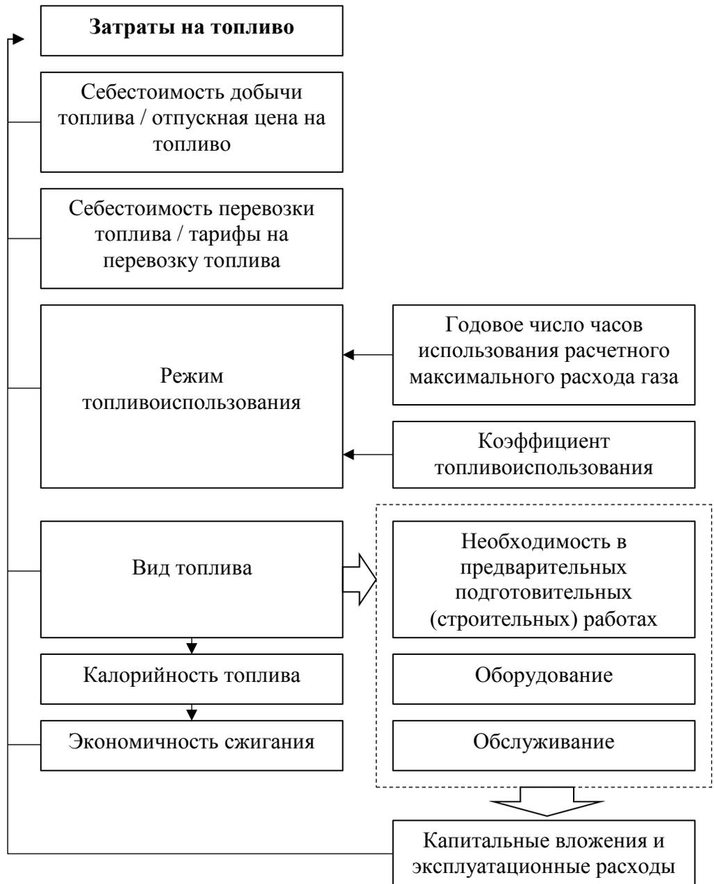
Рисунок 1.5 – Схема, отражающая факторы, влияющие на затраты на топливо при генерации энергии (составлено автором)
