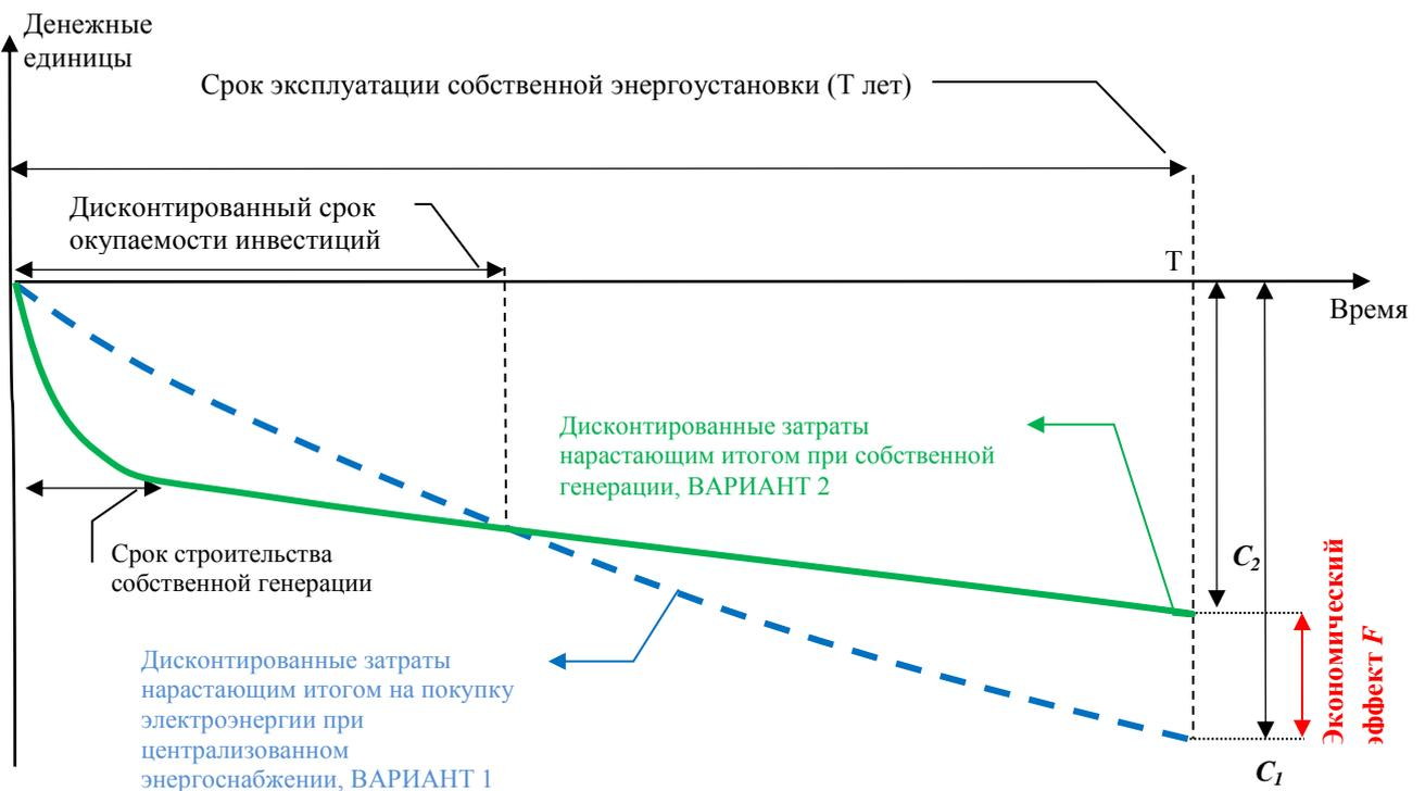
Рисунок 2.1 – Графическое отображение дисконтированных затрат на электроэнергию по двум вариантам электроснабжения (составлено автором)
