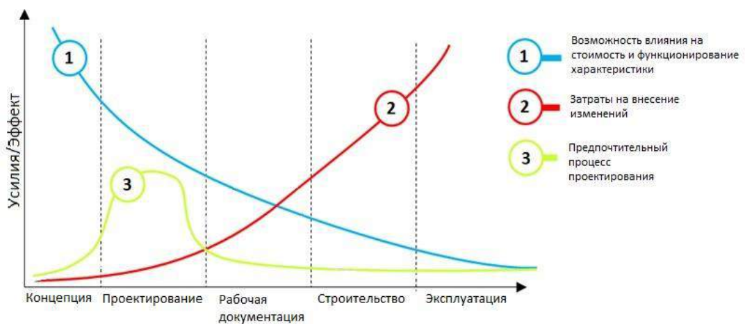
Рисунок 19 – Кривая предпочтительного пути при проектировании объекта [27]
