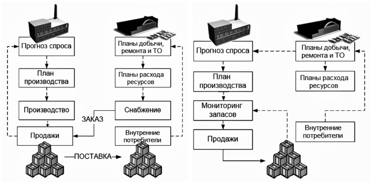
Рисунок 11. Традиционная схема взаимодействия поставщиков и горнодобывающих компаний (а) и предлагаемый вариант реализации технологии VMI при снабжении операционными ресурсами (б).
