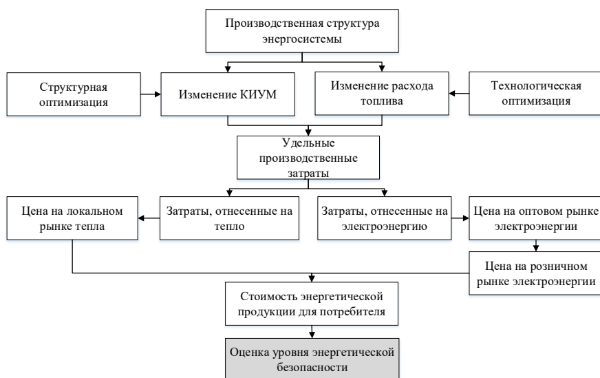
Рисунок 7 – Алгоритм оценки влияния производственной структуры энергосистемы на уровень территориальной энергобезопасности
