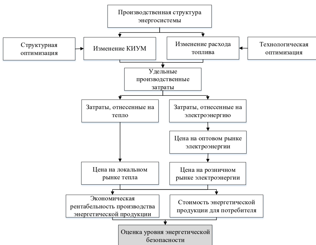
Рисунок 2.15 – Алгоритм оценки влияния повышения эффективности производственной структуры общеэнергетической системы на уровень энергетической безопасности
