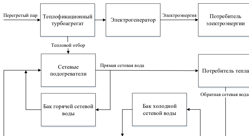
Рисунок 2.49 – Схема аккумуляции сетевой воды на ТЭЦ
