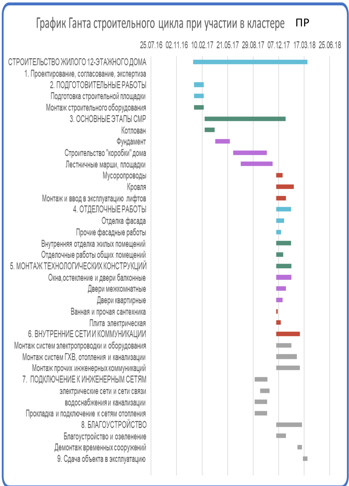
Рисунок 20, б – Сравнение временных затрат в случае участия в кластере ПР и в современных условиях
