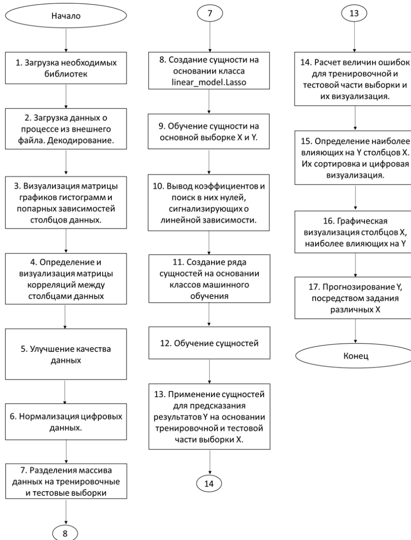
Рисунок 10 – Алгоритм автоматизированной процедуры анализа и прогнозирования функционирования процессов менеджмента качества посредством применения методов машинного обучения (составлено автором)
