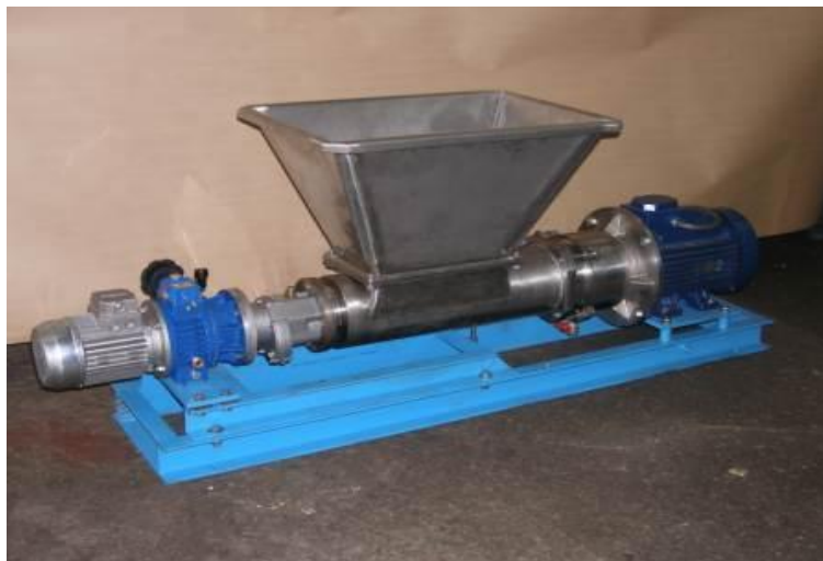
Рисунок 12 – Общий вид измельчителя влажного жома
