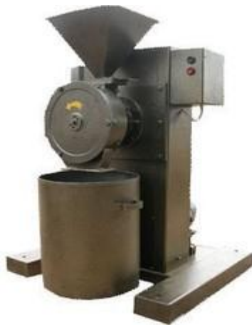
Рисунок 17 – Микромельница модели ММ-10
