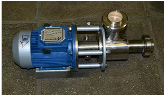
Рисунок 5 – Центробежный насос модели ОНЦ НПО Агромаш
