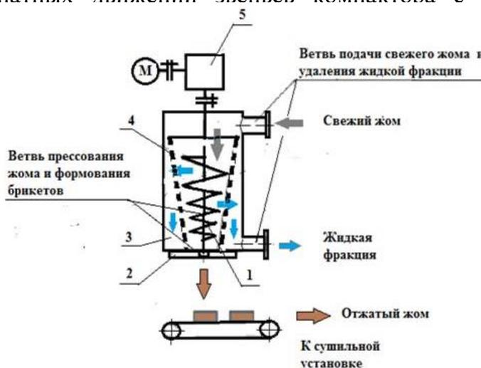
1 – конический шнек, 2 – многолепестковая диафрагма, 3 – корпус, 4 – перфорированная вставка, 5 – редуктор
