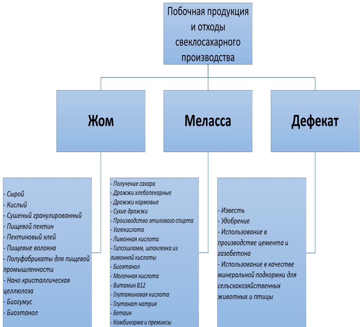
Рисунок 49 – Продукты вторичной переработки побочной продукции и отходов свеклосахарного производства
