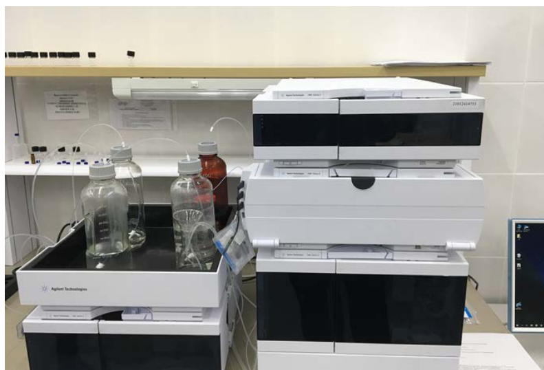
Рисунок 2 – Хроматограф AgilentTechnologies для определения аминокислот, флавоноидов
