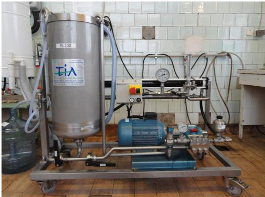
Рисунок 3.4 – Фотография нанофильтрационной установки
