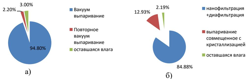
Рисунок 6.3 – Процентное соотношение влаги, удаляемой при а) известном и б) предлагаемом способе производства лактозы и частично делактозированной деминерализованной сыворотки
