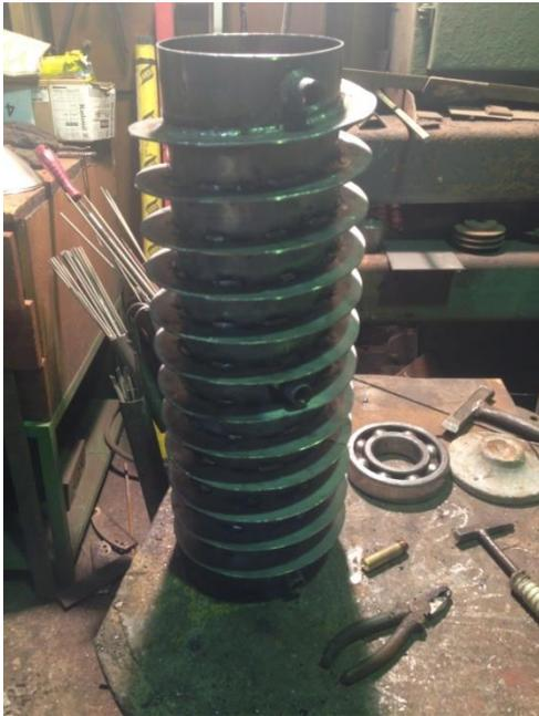
Рисунок 4.5 – Конструкция спиральной направляющей рубашки
