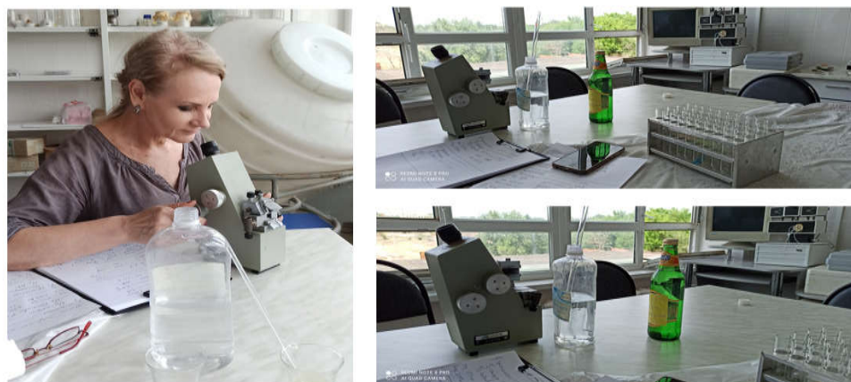
Рисунок 2.4.1 – Проведение исследований на рефрактометре ИРФ-454 Б2М
