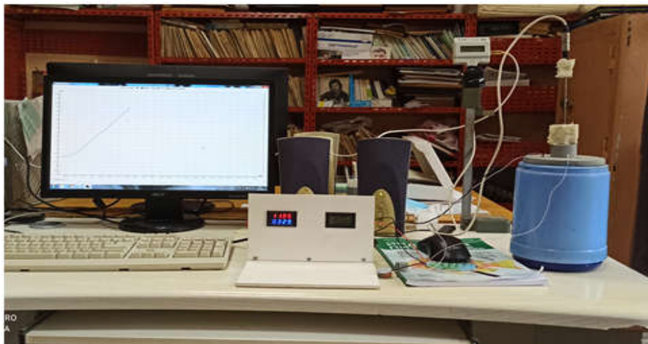
Рисунок 3.1.4 – Экспериментальная установка для определения теплоемкостипищевых материалов
