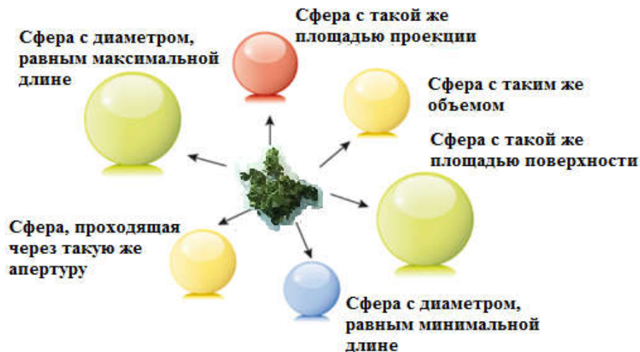
Рисунок 2.1.3 – Пути преобразования реальных размеров частицы в эквивалентный сферический диаметр
