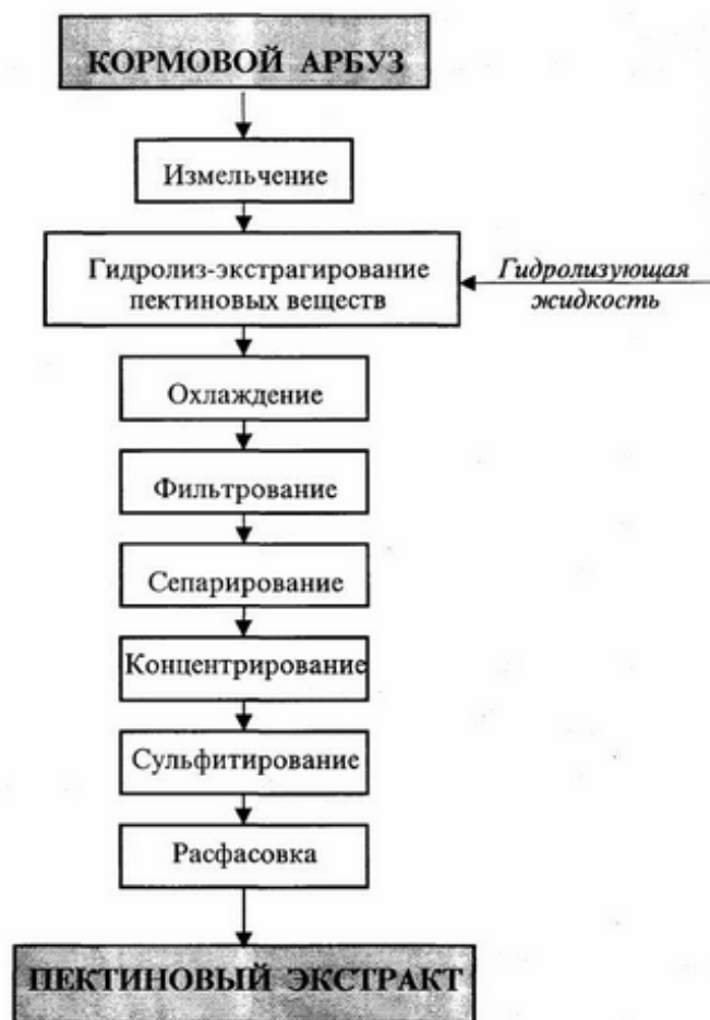
Рисунок 1.3.3 –Этапы выработки пектинового экстракта из арбузов [80]
