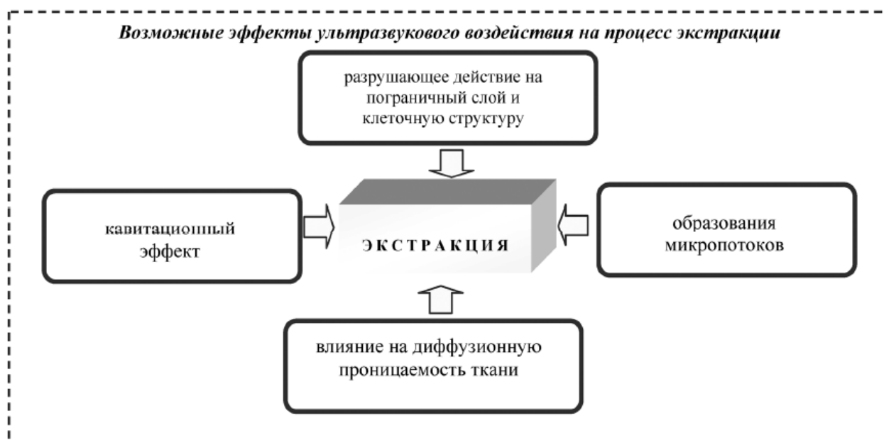
Рисунок 1.3.4 – Эффекты ультразвукового влияния на операцию экстрагирования
