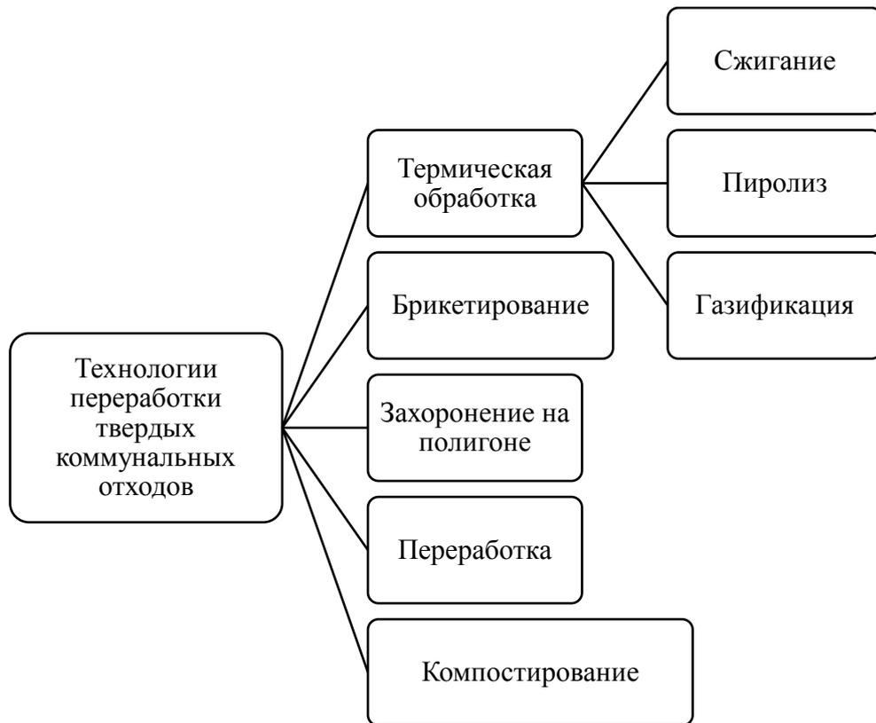
Рис. 1.4 – Типы технологий переработки твердых коммунальных отходов
