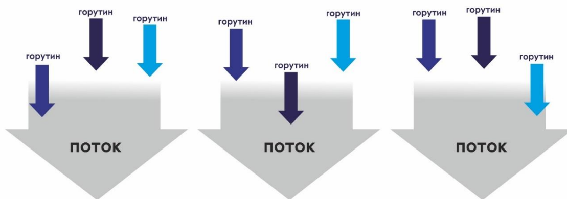
Рисунок 5.3 – Выполнение нескольких горутин на одном потоке ОС
