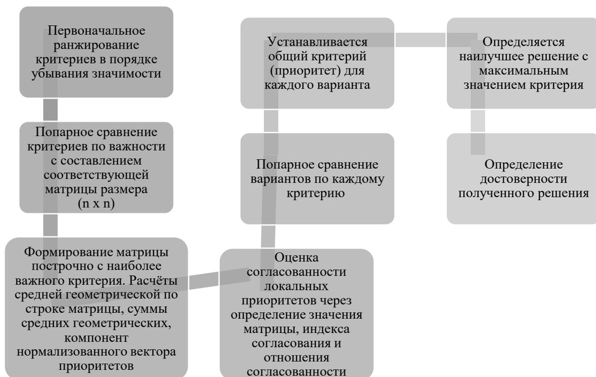
Рисунок 17 – Схема метода иерархий
