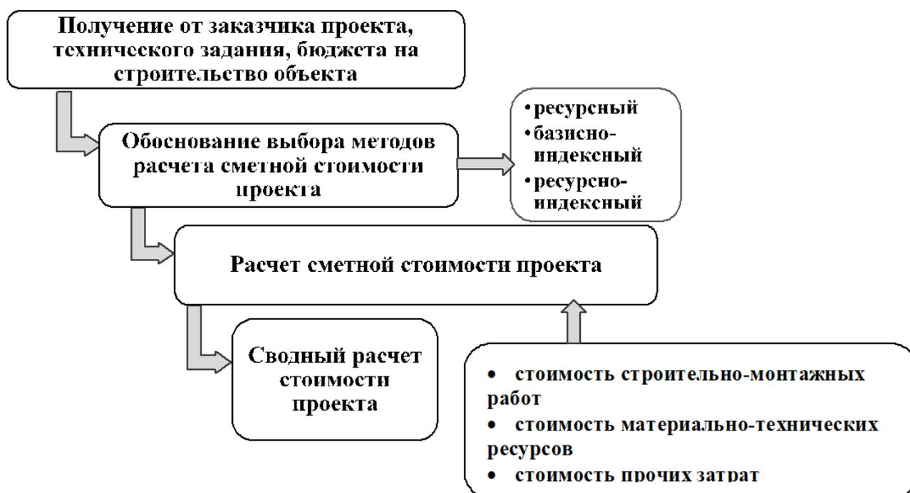
Рисунок 3.5 – Схема формирования сметной стоимости проекта строительства
